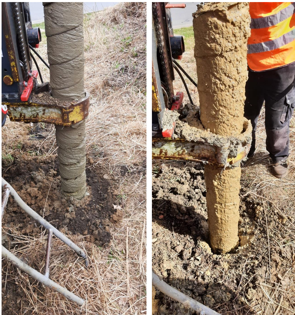
OBR. 9.1 VLEVO MĚKKÉ JÍLOVITÉ HLÍNY (2,7 m) , VPRAVO ZVODNĚLÉ JÍLOVITÉ ŠTĚRKY (4,0 m)
